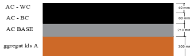
Jambar 4.5. Lapisan Perkersan dengan Lapis Fondasi berbutir (Sumber : Manual Desain Perkerasan Jalan. 2017)
